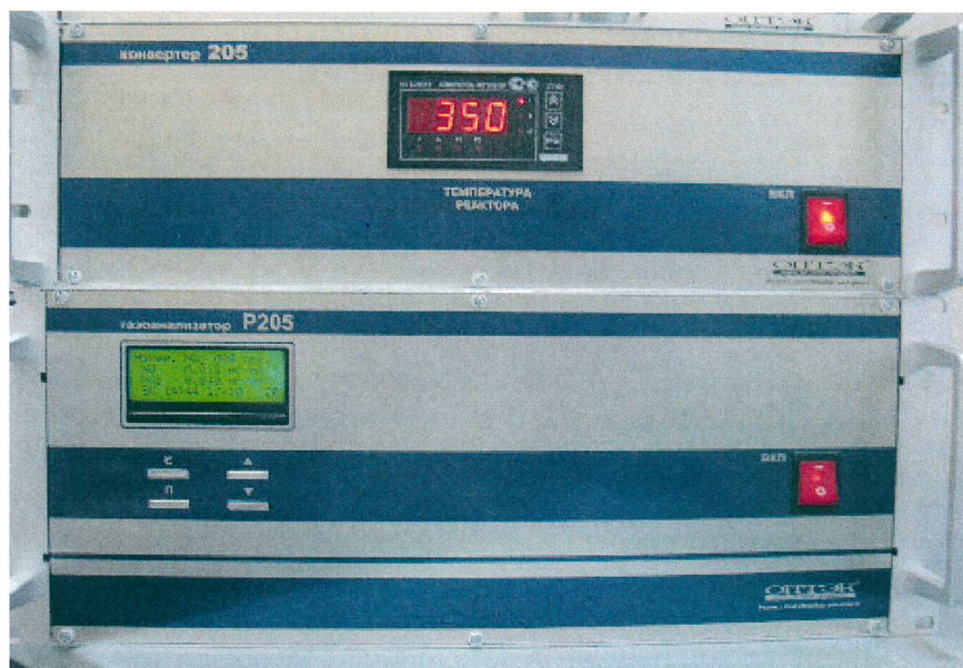
Рисунок 1 - Вид передней панели газоанализатора Р-205
