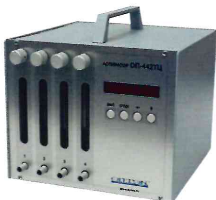
Рисунок 1 – Внешний вид пробоотборников мод. ОП-442ТЦ, ОП-412ТЦ, ОП-431ТЦ
