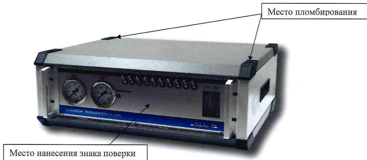
Рисунок 2 - Общий вид генератора ГС-2000 (исполнение 2). с указанием мест пломбирования и нанесения знака поверки
