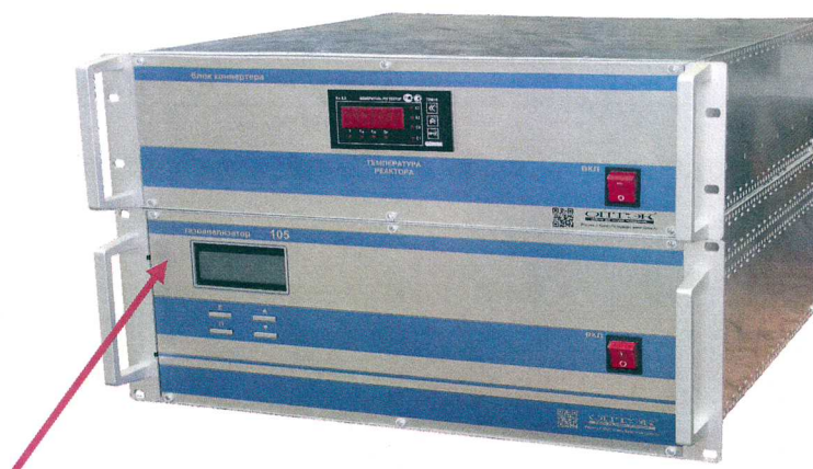
Рисунок 2 - Общий вид газоанализатора 105 модификаций Р-105, Н-105 обозначение места нанесения знака поверки (указано стрелкой)
