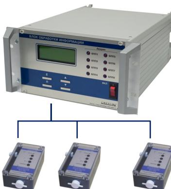
Схема прибора МГЛ-20М: блок обработки информации и блоки первичных преобразователей (БПП) - от 1 до 8 шт.
