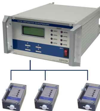
Схема прибора МГЛ-19М: блок обработки информации и блоки первичных преобразователей (БПП) - от 1 до 8 шт
